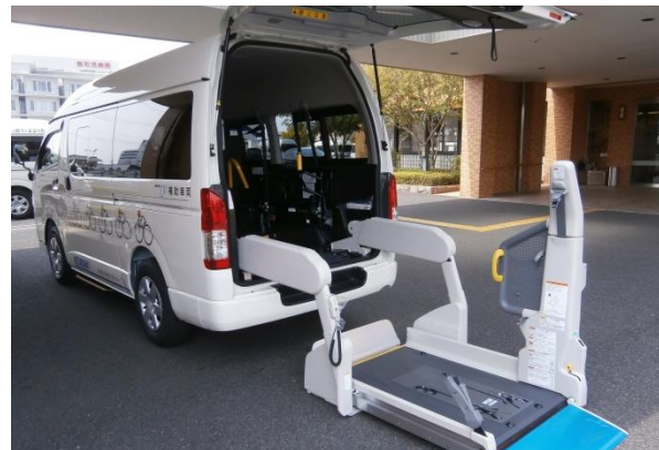
＜移送車3:後部リフトアップ＞
